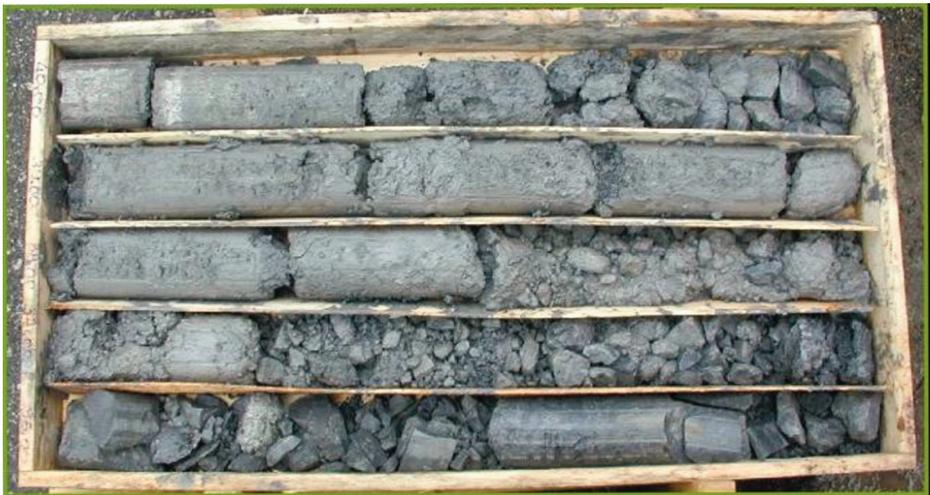
*Fig. 4 - Livelli argillitico-siltitici intensamente fratturati nelle Arenarie di Monte Gottero.*
