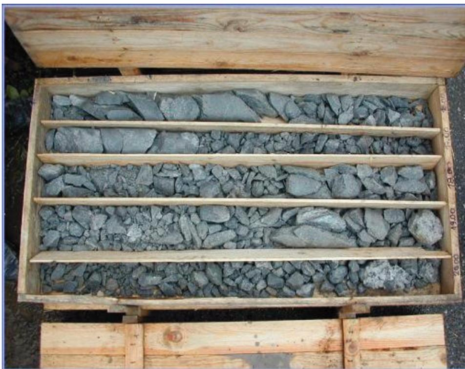
*Fig. 3 Carote di Arenarie del Gottero ridotte a una breccia centimetrica dall'intensa tettonizzazione.*
